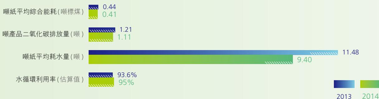
為了響應全球推行低碳經濟的發展趨勢，減少空氣污染，本集團近年鼓勵採用清潔能源，其中位於四川的工廠自投產起便採用天然氣作為燃料，而位於北京之工廠亦已完成煤改氣工作。在減少用水方面，本集團各生產基地已配備成熟的水循環使用系統，以世界一流的淺層氣浮裝置、纖維過濾機、微濾機及同向流造紙廢水處理設施等，實現淨化水循環再用。目前，我們的造紙機器全部使用回用水，不單有效保護水資源，亦降低生產成本，達至實現經濟效益和環境保護的雙贏。此外，本集團亦積極開發廢物利用方案。對於生產過程中產生的各類固體廢物，我們有一套完善的處理方法，透過招標形式挑選合資格的承包商進行廢物回收，而收購危險廢物的承包商則需要擁有環保部門認可的處理資格，避免二次污染。我們亦專門在各生產基地設置回收紙、塑膠及鋁的設施，以降低環境負荷。
